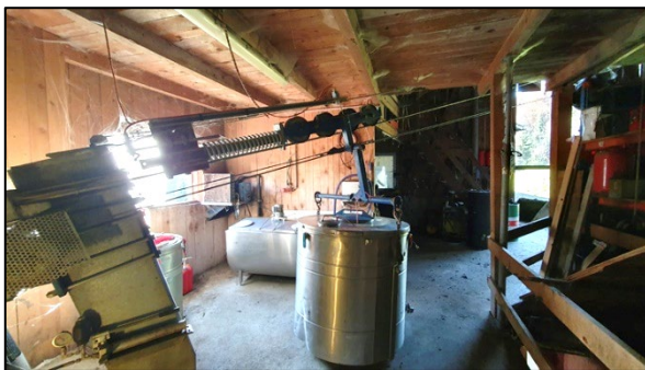
Abb 93: Talstation der Seilbahn mit Milchtransportbehälter
