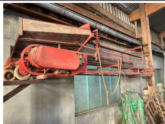
Bild 34: Höhenförderer (Nr. 8) (Verlängerung im Dachboden des Wirtschaftsteils montiert)
