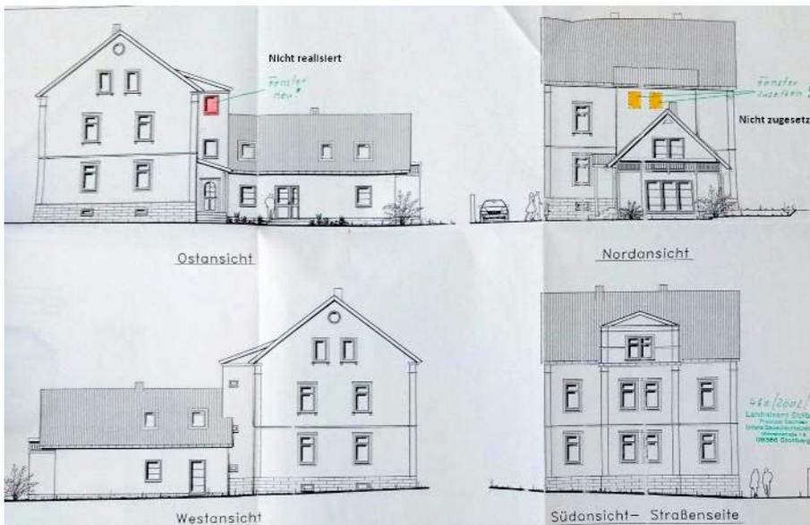
Abb. 4: Auflage: Fenster Altbestand schließen F90 und Fenster neu seitlich
