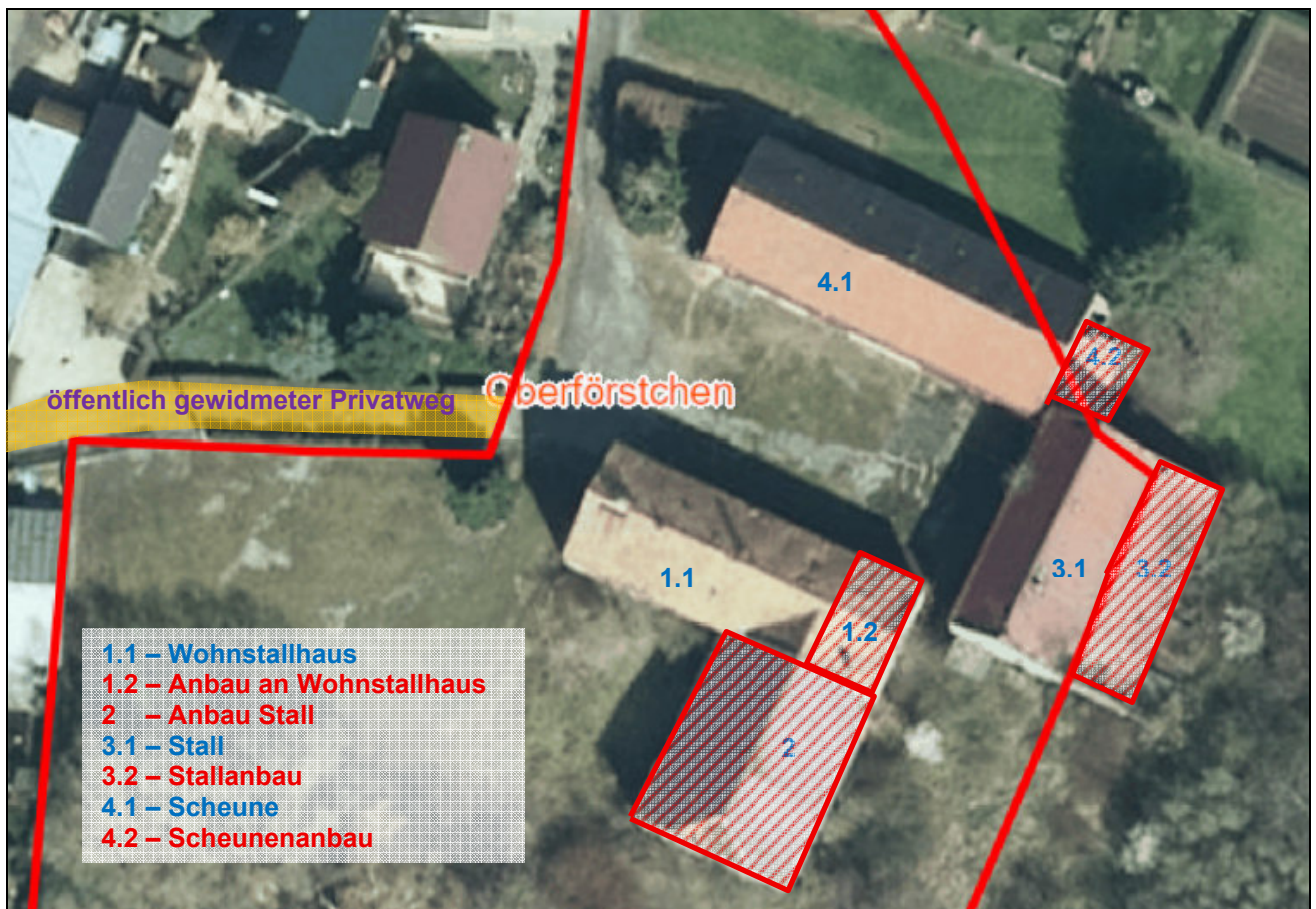
Luftbild mit Kennzeichnung der abzubrechenden Gebäudeteile
