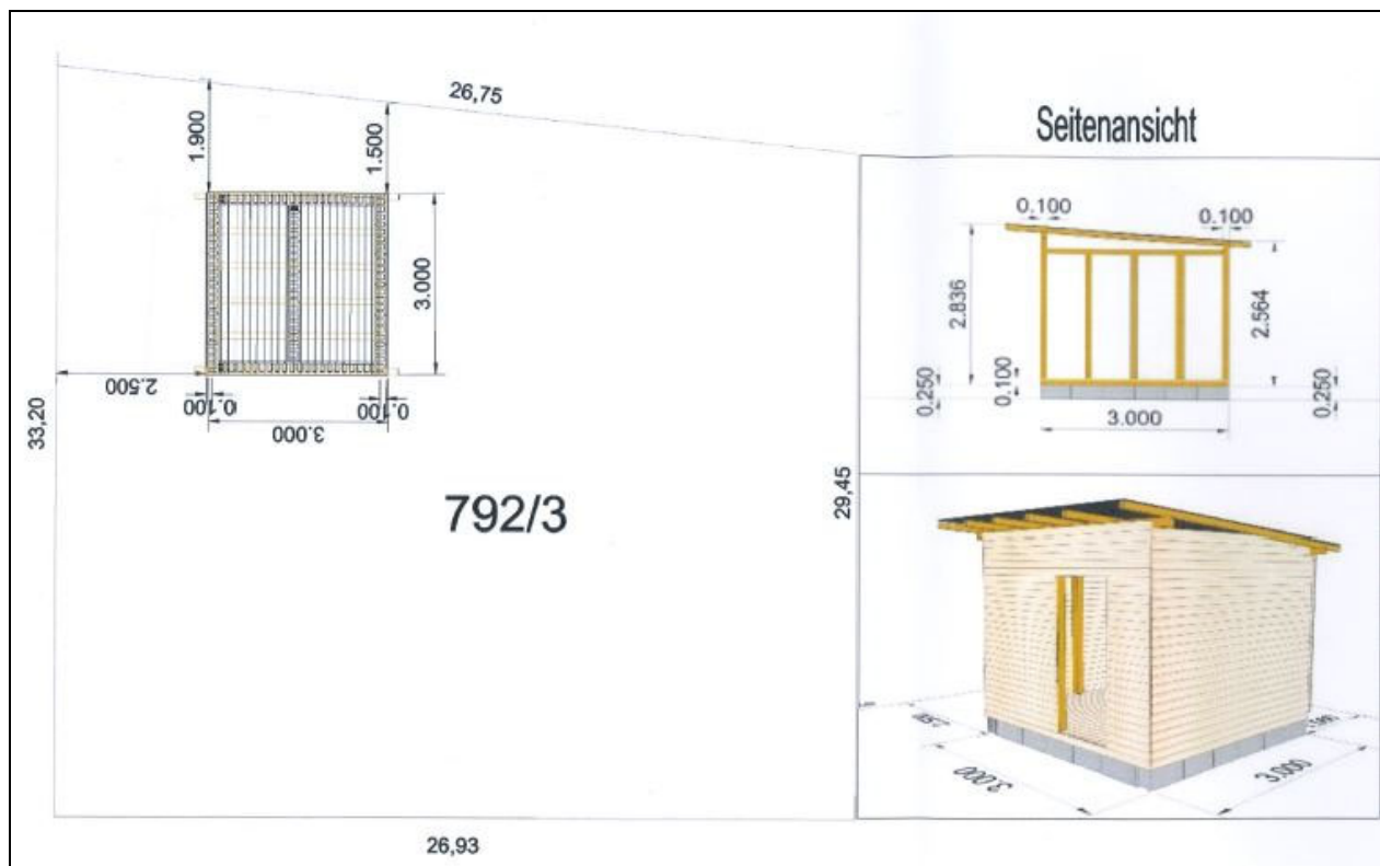
Grundriss, Schnitt, Ansicht Geräteschuppen (aus Bauanzeige 2016)
