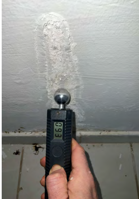
Lichtbild 13: Detail, Messung der Bauteilfeuchte im Keller- und Dachgeschoss
