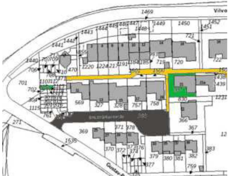
**Straßenausbau:** Wohnwege (gelb gekennzeichnet) mit Betonsteinpflasterung, Zufahrt und Wendehammer asphaltiert.
