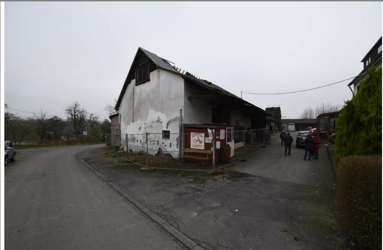
Bild 1 Zufahrt zur Hofstelle von der Kuhlener Straße mit Blick auf die Scheune / Kuhstall mit stark geschädigter Dachkonstruktion
