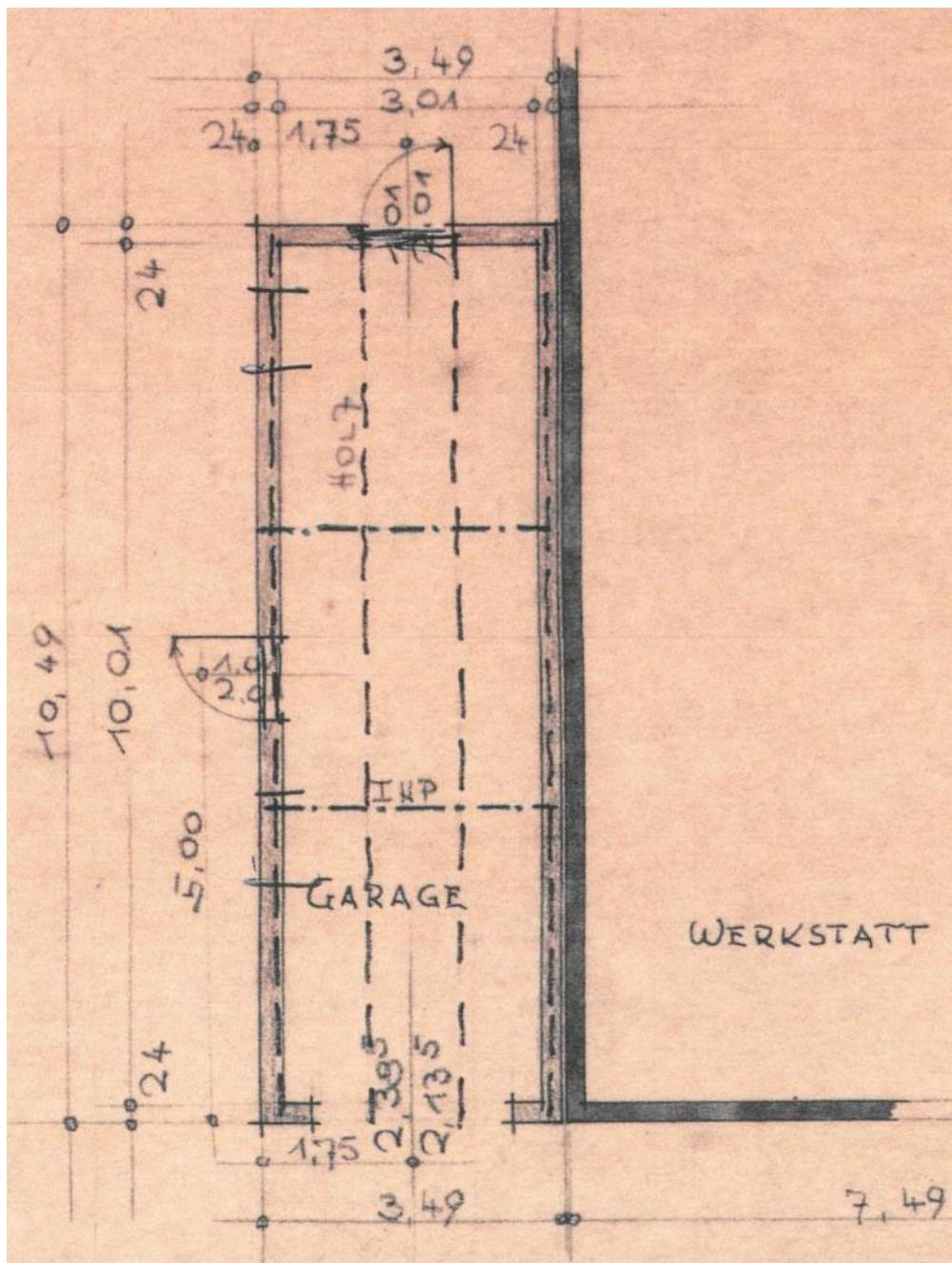
**Grundriss Pkw-Unterstand (lt. Bauakte):**
