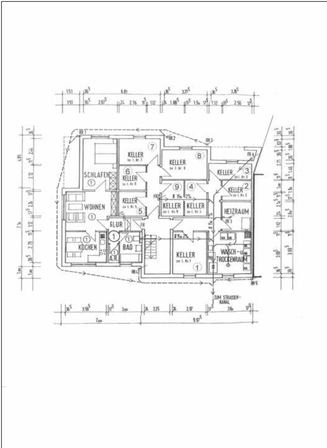
Abbildung 20 Grundriss vom Kellergeschoss, in der Örtlichkeit modifiziert aus den Bauakten der Stadt Hamm, ohne Maßstab
