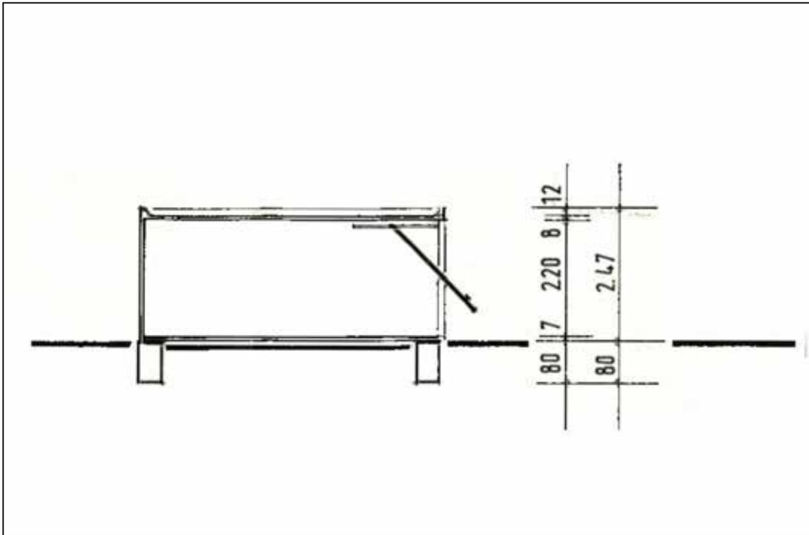
Abbildung 44 Schnitt durch das Garagengebäude
