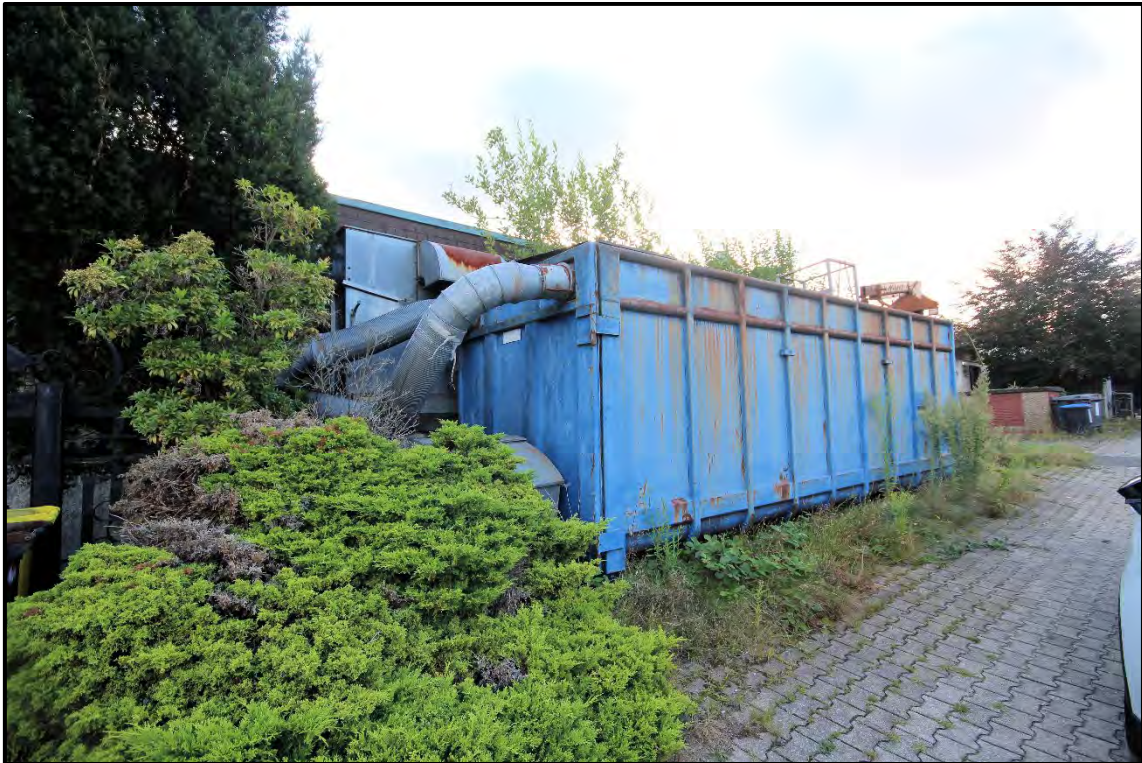
Bild 3: Container für die Absaugung von Holzspänen, vorherige Nutzung als Tischlereibetrieb (nicht Bewertungsbestandteil)
