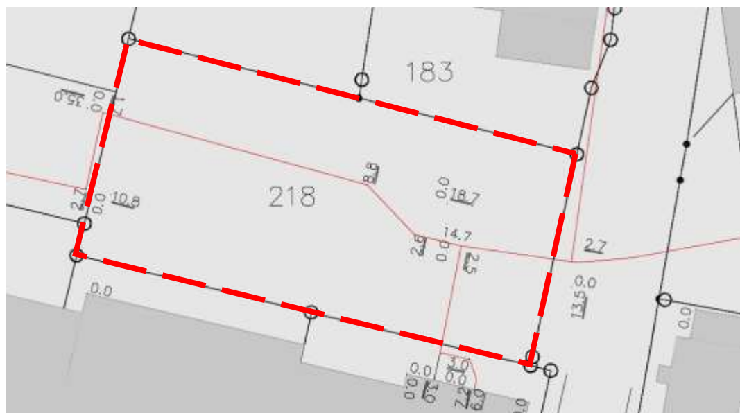
- Leitungsführung der Nahwärmeleitung -
