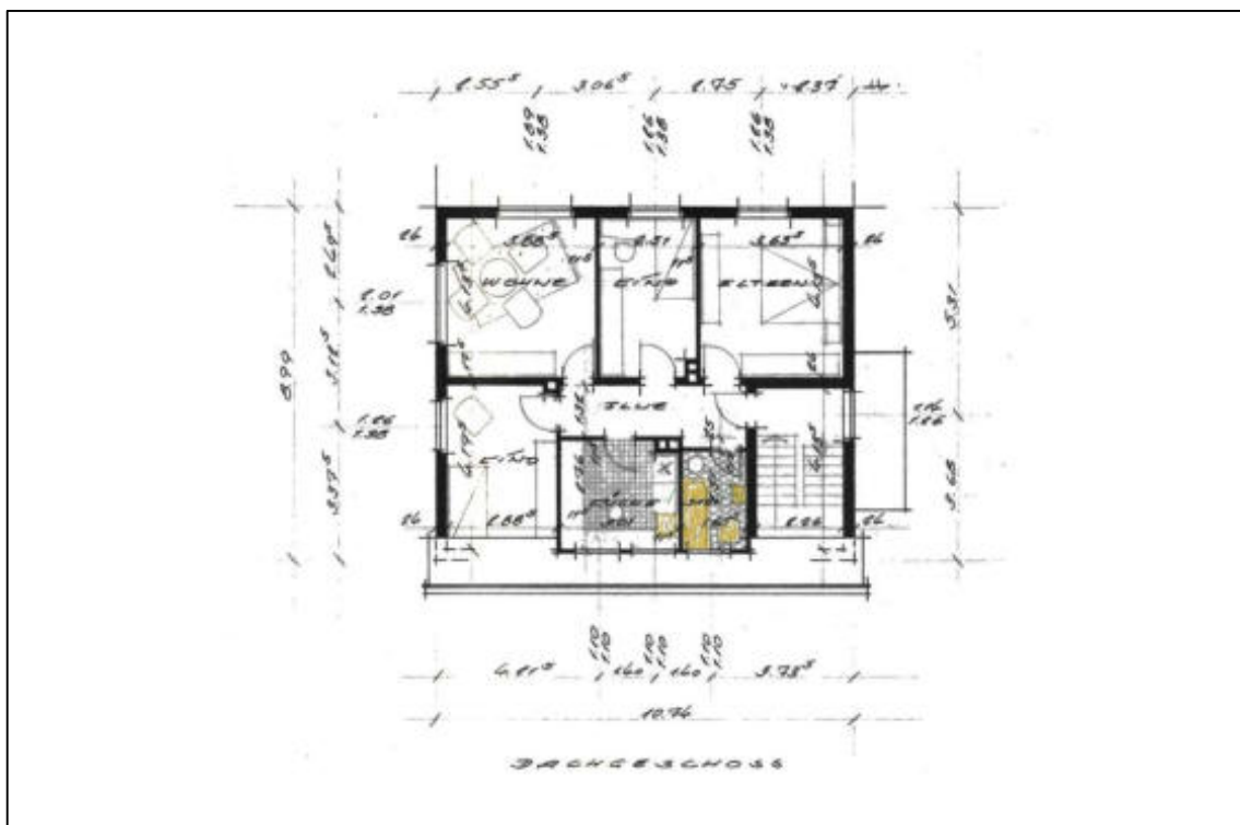
Abbildung 33 Grundriss vom Dachgeschoss aus den Bauakten der Stadt Werl, ohne Maßstab © Stadt Werl
