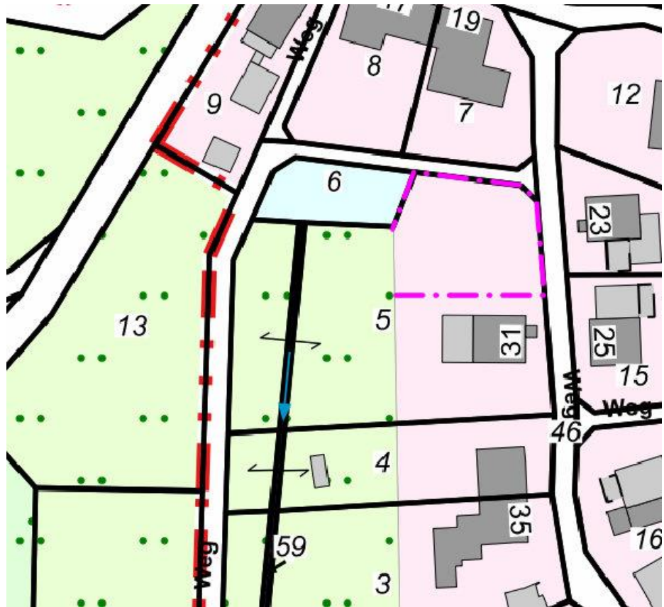
Abbildung 11 mögliche Teilung des bebauten Grundstücks, M ca. 1 : 1.000
