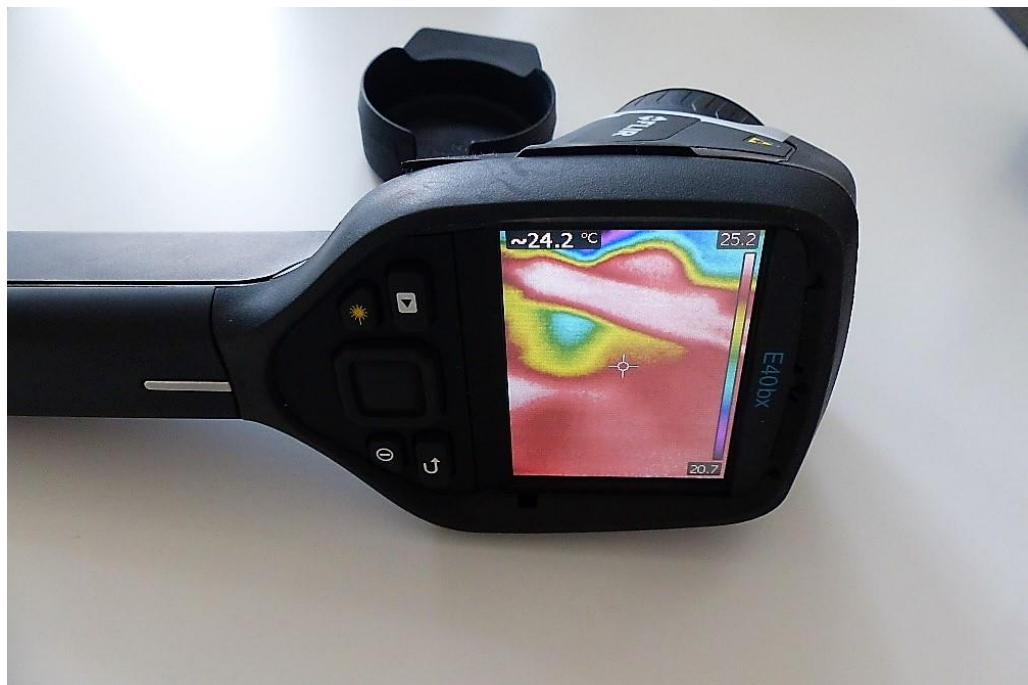
Abbildung 25 - Infrarotkamera FLIR Exx series, E 40 bx Wärmebildkamera
