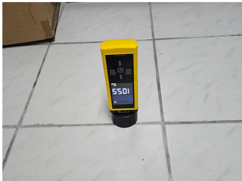
Abbildung 15 - Messung auf dem Fliesenboden 105 Digits = Feuchtigkeit)
