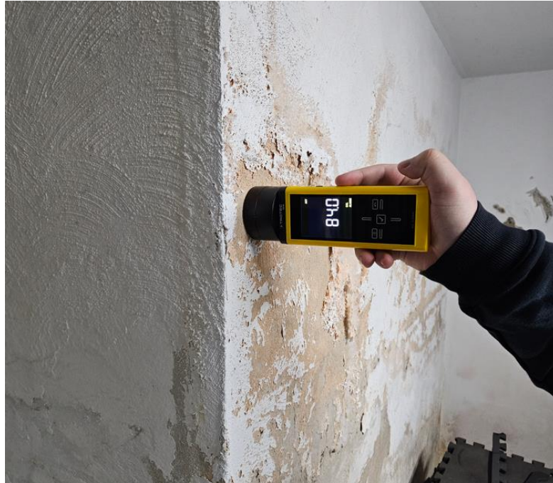
Abbildung 12 - Messung 84 Digits (Feuchtigkeit)
