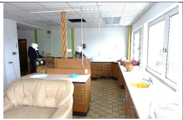
Labor: Boden: Fliesen; Wände: verputzt und gemalt; Decke: abgehängte Elementdecke mit integrierten Lichtelementen; Sanitärausstattung: 1 Waschbecken mit Armatur;
