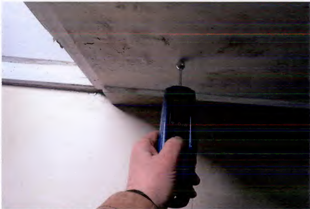
Abb. 52: 158,3 Digits an der Innenseite der Kelleraußenwand zum Kellerabgang
