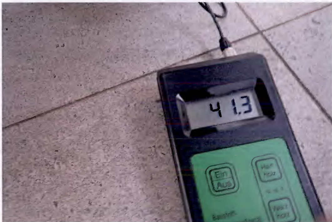
Abb. 40: 41,3 Digits Feuchte auf der Betondecke
