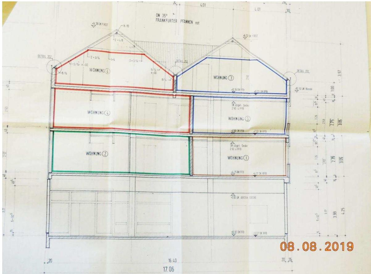
Abb. 4: Schnitt straßenseitiger Bereich (nicht maßstabsgetreu, aus Bauakte)
