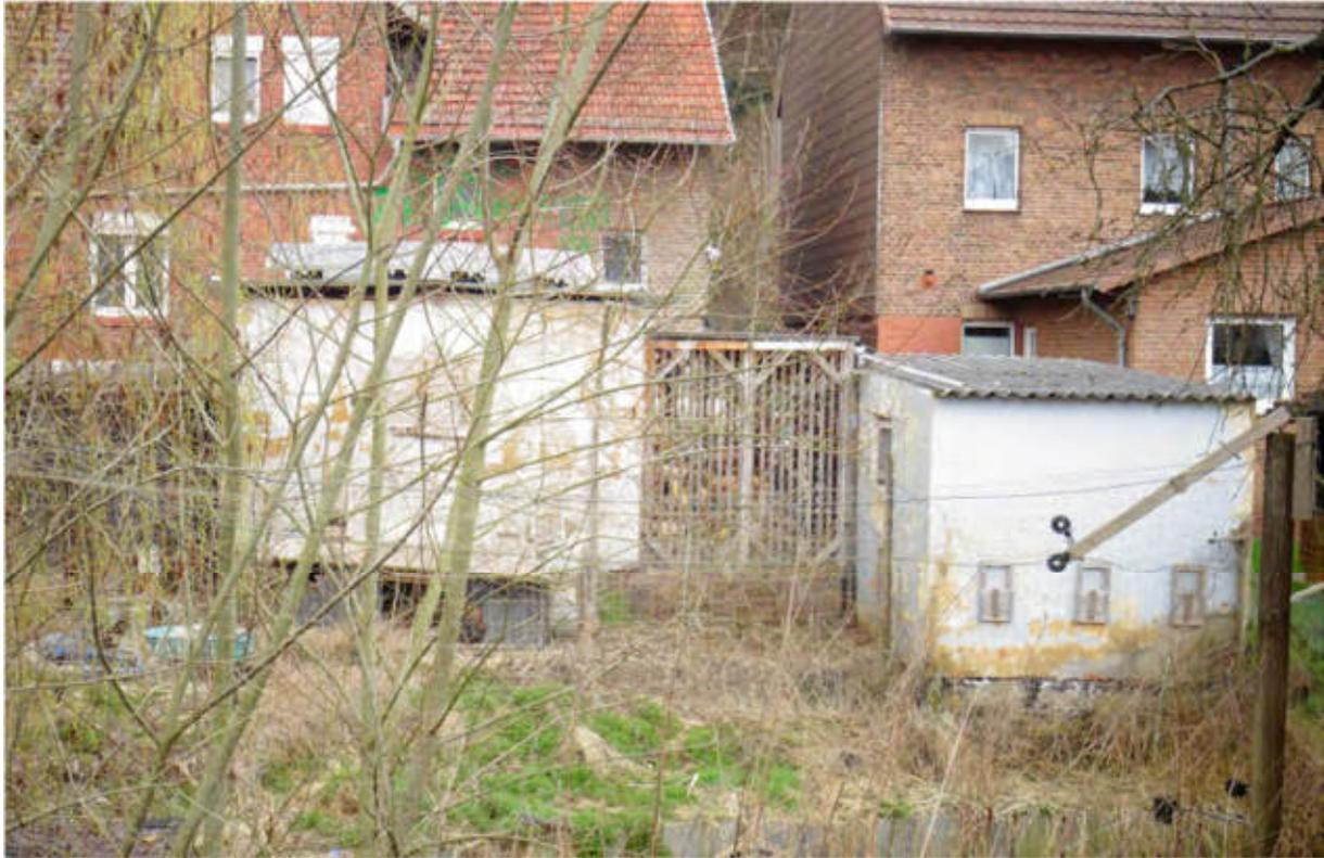
massive Schuppen aus den Baujahren um 1960. Pultdach mit Faserzementwellplatten-Eindeckung, Holztore; auf einem der Schuppen befindet sich eine PV-Anlage (Balkonkraftwerk)
