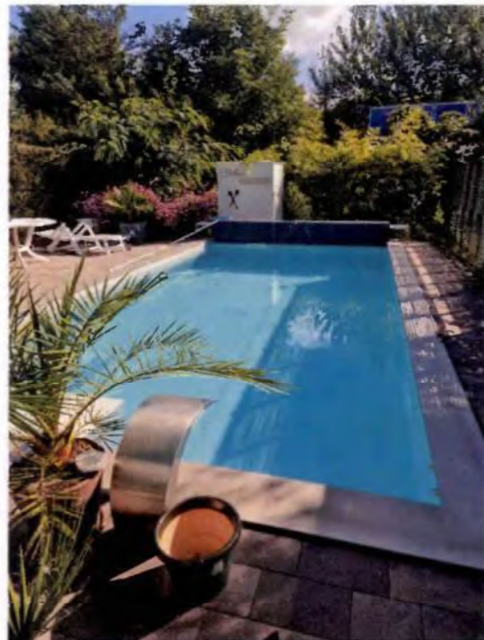
... als ebenerdige (wärmeisolierte) Stahlbeton-Wanne in Rechteckform, Folienbekleidung, Wasservolumen: rd. 54 m³, Abmessungen (L x B x H): 800 cm x 400 cm x 168 cm
