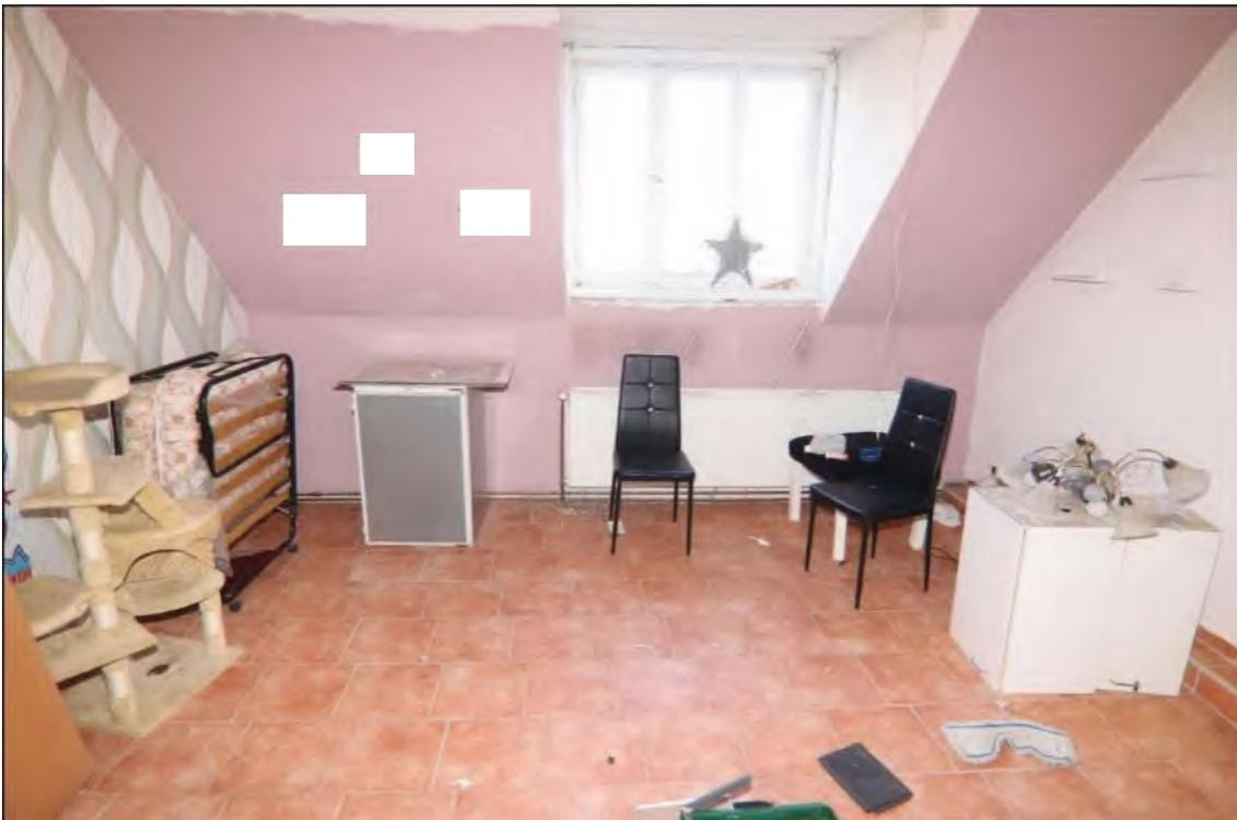
Blick in den Wohnraum 1 mit einem straßenseitigem Gaubenfenster. Auch hier ist der Boden gefliest worden. Unter dem Fenster ist ein breiter Plattenheizkörper installiert. Die Heizungsrohre verlaufen hier sichtbar auf Putz im Bereich vom Fußboden.
