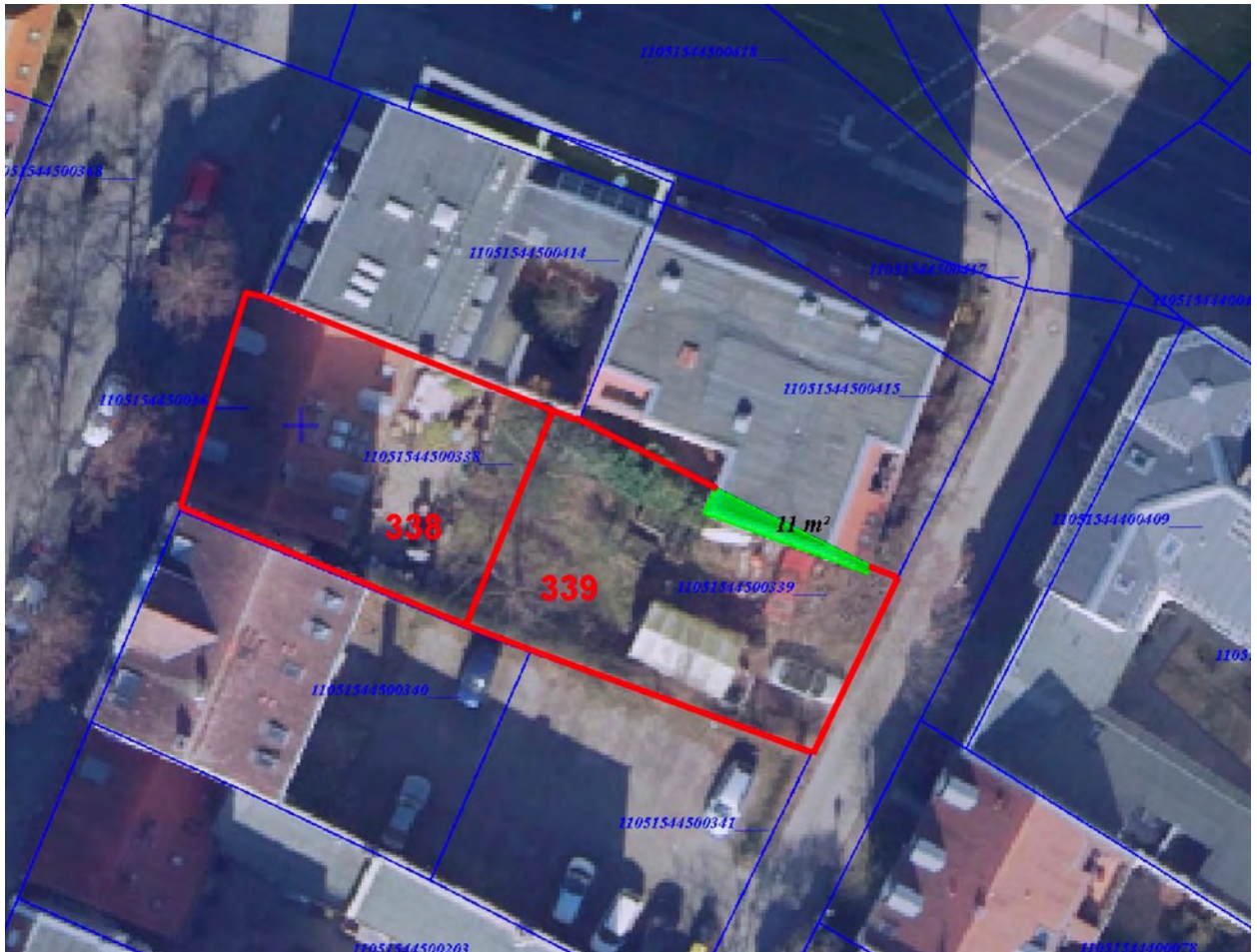
Abb. 1 Darstellung des Überbaus anhand Überlagerung von Flurstückgrenzen und Luftbild, Fläche des Überbaus grün markiert (Bildquelle: FIS-Broker)
