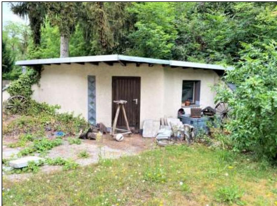
im rückwärtigen Garten des Grundstücks Fürstenauer Weg 6 in der nord-östlichen Grundstücksecke aufstehender Massivschuppen als wohnraumgleich ausgebauter Laube mit erheblichen Mängeln insbesondere hinsichtlich der Dachdichtung und -konstruktion (Abriss)
