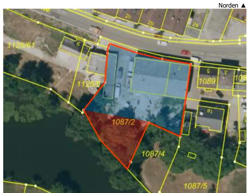
Auszug Orthophoto mit überlagerten dxf-Vektordaten und farblicher Kennzeichnung der Teilflächen „Baulandfläche“ und „Böschung/Geringstland“
