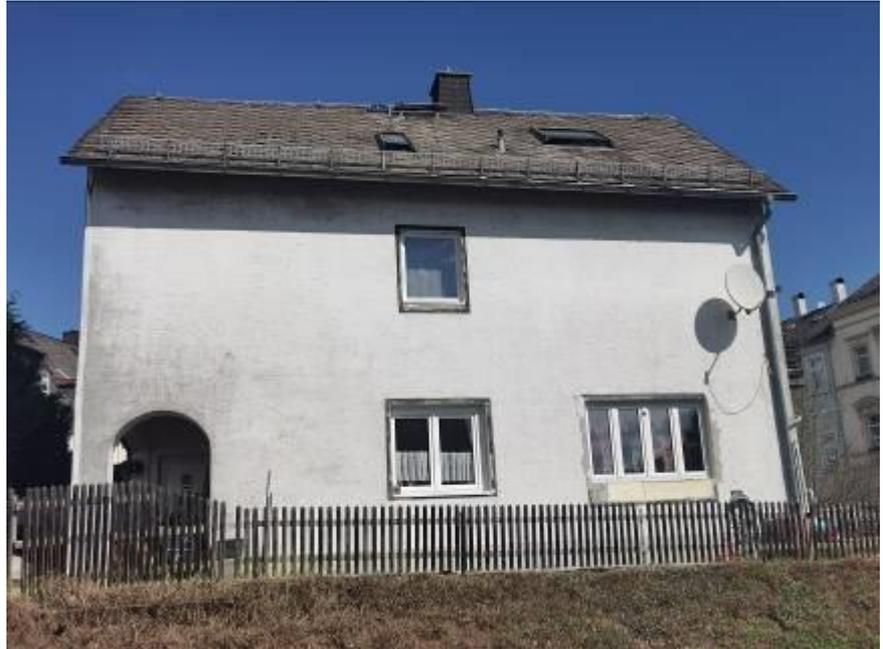
Auf der Westseite des Gebäudes ist die Fassade mit Eternitplatten verkleidet. Die Sanierung der gesamten Fassaden wird in der vorliegenden Wertermittlung kostenmäßig berücksichtigt
