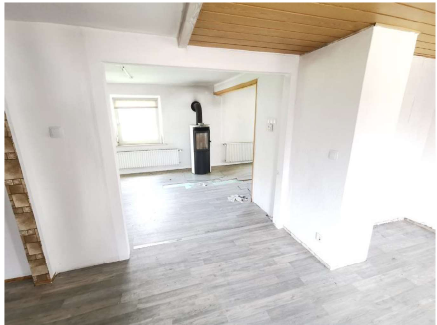
Blick in den großen offenen Wohnbereich im Obergeschoss des Wohnhauses. Bei den Umbaumaßnahmen im Jahr 2021 wurden im Obergeschoss mehrere Innenwände entfernt und somit ein „offener“ Wohnbereich geschaffen
