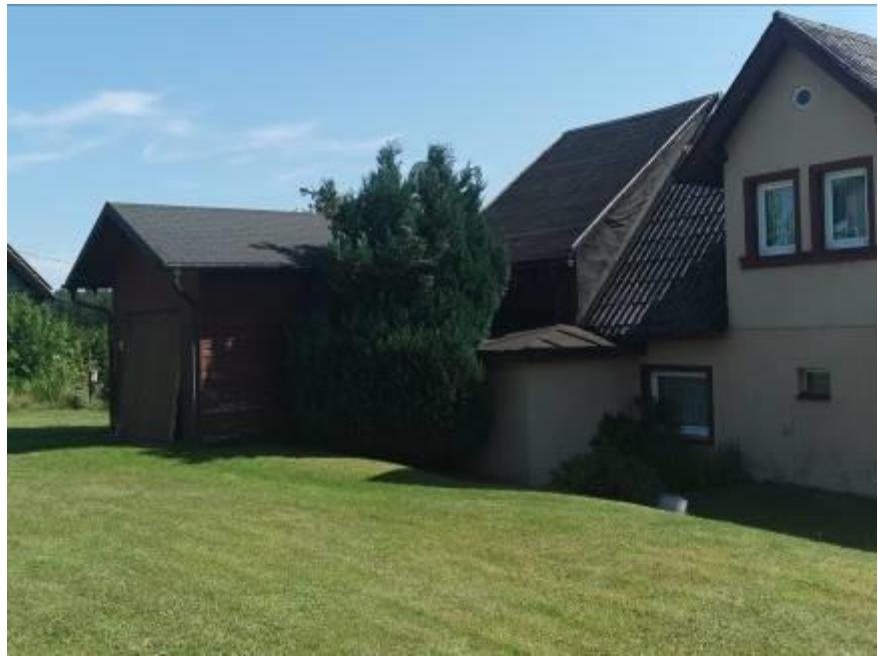
Blick auf den Wohnhausanbau und die Holzgarage von Osten. Die Garage wurde in Holzkonstruktion mit Außenverschalung in horizontaler Nut- und Federschalung erstellt. Der Anbau wurde ebenfalls mit horizontaler Holz- Außenverschalung gestaltet. Dacheindeckung als Bitumen-Schindeleindeckung
