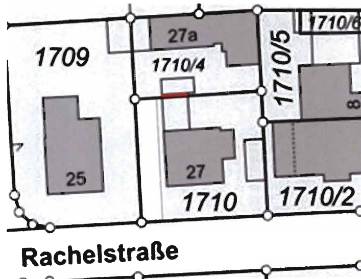
Abbildung 4: vergrößerter Auszug aus der digitalen Flurkarte, ohne Maßstab (überbaute Fläche rot markiert), © Geodatenbasis: Bayerische Vermessungsverwaltung
