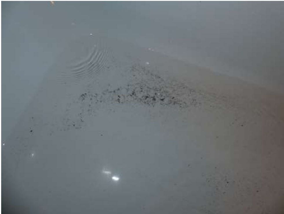
Bild 26: Rückstände im Leitungswasser (Badewanne)
