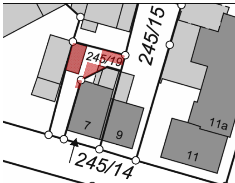
Darstellung des Überbaus (rote Markierungen) von Grundstück Flst. 245/14 auf Grundstück b) Flst. 245/19 Plangrundlage Katasterkartenwerk, © Bayerische Vermessungsverwaltung, Amt für Digitalisierung, Breitband und Vermessung
