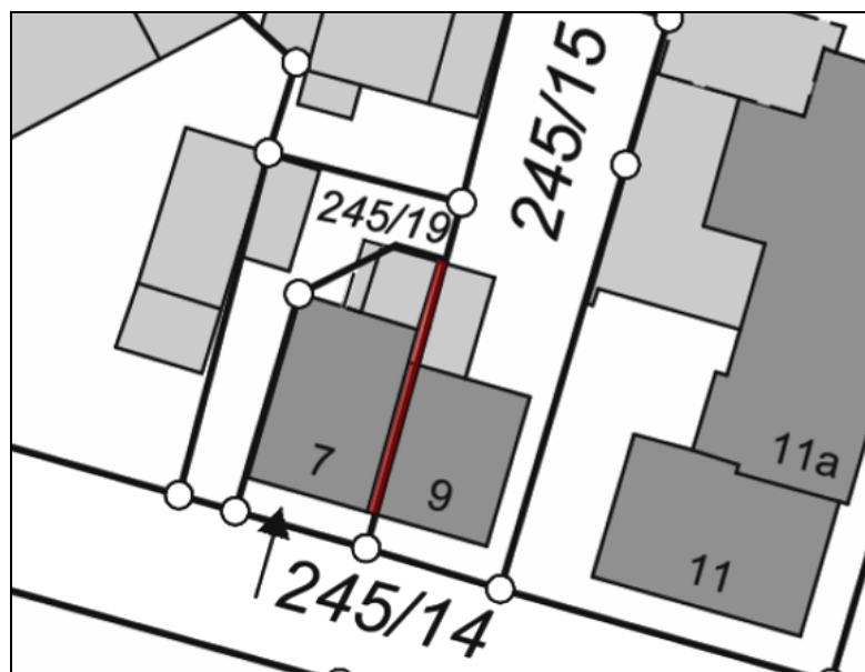
Darstellung des Überbaus (rote Markierung) von Grundstück a) Flst. 245/15 auf Grundstück Flst. 245/14 Plangrundlage Katasterkartenwerk, © Bayerische Vermessungsverwaltung, Amt für Digitalisierung, Breitband und Vermessung
