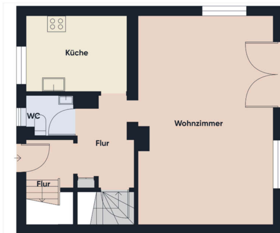
Abbildung 5 Grundriss Erdgeschoss aus dem Laser-Lidarmessgerät
