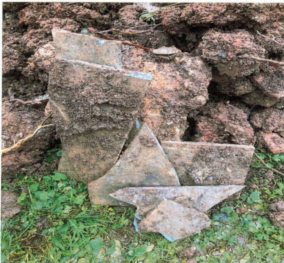
Bild 6: Blick auf wenige aussortierte asbesthaltige Dämmplatten (28.11.2025)
