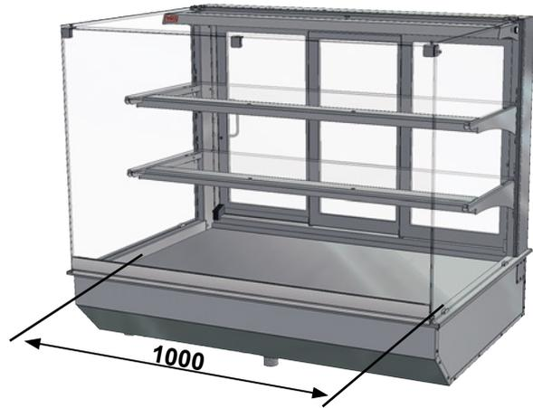
Die Warenböden sind für EN-Maße geeignet. Einfacher Einbau durch Einhänderand. Unterhalb der Kühlwanne ist eine digitale Abtau- und Temperatursteuerung montiert. Für verschiedene Lebensmittel sind zwei Luftgeschwindigkeiten wählbar. Das superflache Bedienteil (Einbautiefe ca. 20 mm) kann für die Montage in die Möbelfront herausgenommen werden (Leitungslänge ca. 1 m).
