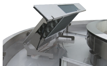
Einfache Reinigung des Wannenbodens durch Liftverdampfer.
