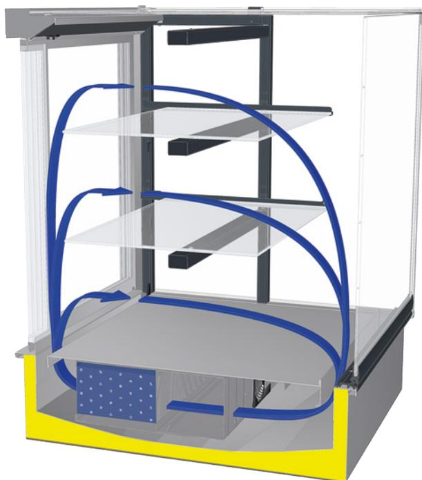
Durch ein direktes Anblasen trocknen empfindliche Lebensmittel unnötig aus. Die neue intelligente WIHA-Lüftersteuerung IFC sorgt dafür, dass nur so viel Luft über die Waren geführt wird, wie es zur sicheren Kühlung erforderlich ist. Dadurch bleiben die Waren länger frisch.
