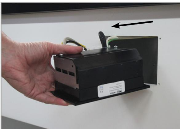
Abbildungen: Einbau einer Steuerung der Serie TMP 600 mit Kompaktgehäuse ohne die Anschlussleitungen zu lösen.
