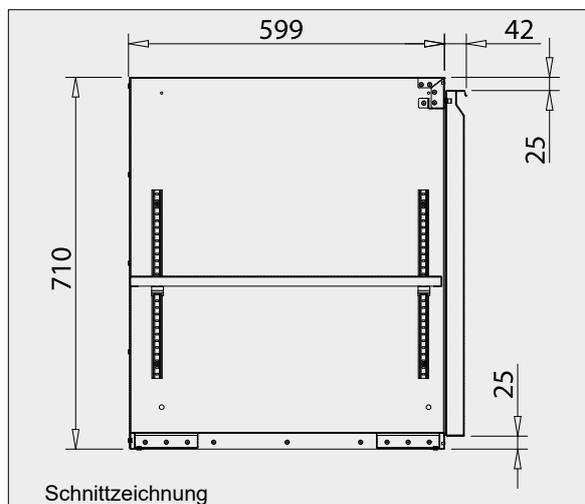
Die Kühlunterbauten der Serie KUB 710 können mit den hier aufgeführten Trockenmodulen kombiniert werden. Bei Bedarf können sowohl die Kühlunterbauten als auch diese Trockenmodule mit Füße (Stellhöhe ca. 100 bis 140 mm) ausgestattet werden. Sind die äußeren Seiten sichtbar, müssen diese mit einer bauseitigen Dekorplatte oder mit der Edelstahl-Endabschlussplatte geschlossen werden.
