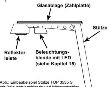
Abb.: Einbaubeispiel Stütze TOP 3535 S mit Beleuchtungsblende und Wärmestrahler
