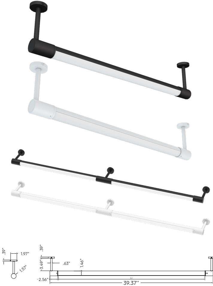
Technical Drawing: 1.97" (D) x 39.37" (W) x 5.79" (H)
