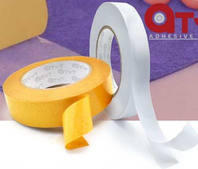
Cinta de doble cara compuesta por un soporte de tejido no tejido (TNT) recubierta por ambos lados por un adhesivo de caucho y protegido en su parte superior con un liner de papel siliconado.
