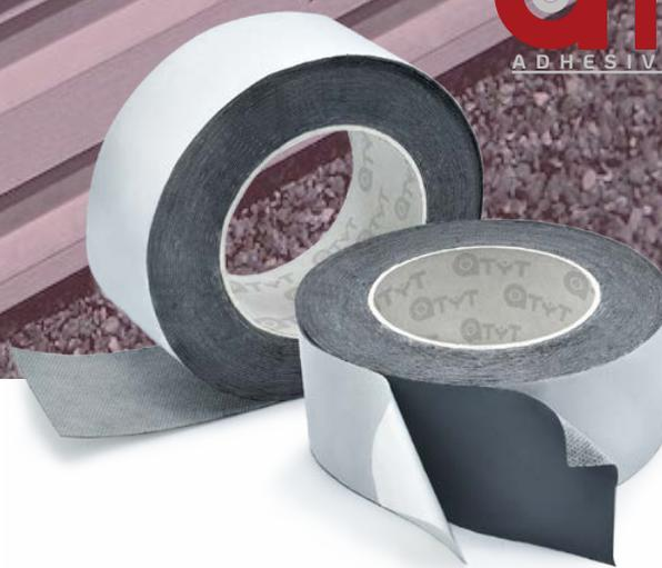
Cinta de butilo “Fleece” compuesto por un soporte de PP no tejido de 50 g/m<sup>2</sup> en la parte superior (de color blanquecino), cubierto por un adhesivo modificado de caucho elastomérico butílico y recubierto por ambos lados con un liner siliconado de 120 µm de color blanco.
