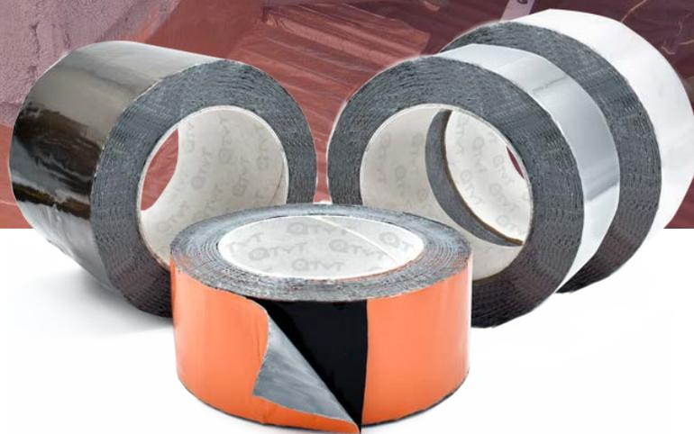
Cinta de butilo sellador compuesto por una combinación de ALU/PET de 55 µm de espesor (25 µm ALU / 23 µm PET) en su parte superior, un adhesivo modificado de caucho elastómero butílico y recubierto por un liner de PP de 70 µm en negro / blanco en la parte inferior. La cinta está pensada para ser utilizada en aplicaciones como impermeabilizaciones, reparaciones y sellados permanentes.
