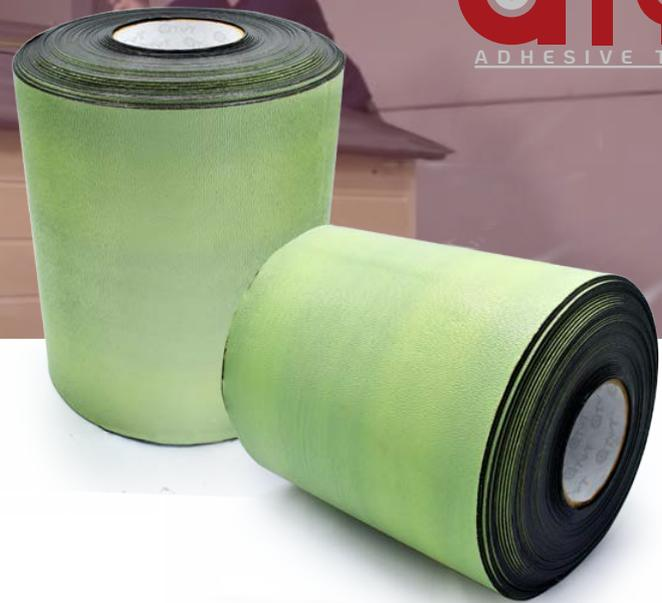
Bitumen autoadhesivo constituido por un compuesto bituminoso embadurnado sobre una película de Polietileno HDPE de 100 µm con laminado cruzado y protegido por un liner crepado (60 µm) MPE siliconado a una cara. La mezcla equilibrada, de varios cauchos sintéticos y bitumen, garantiza el anclaje permanente en materiales como hormigón, piedra, plástico y metal.
