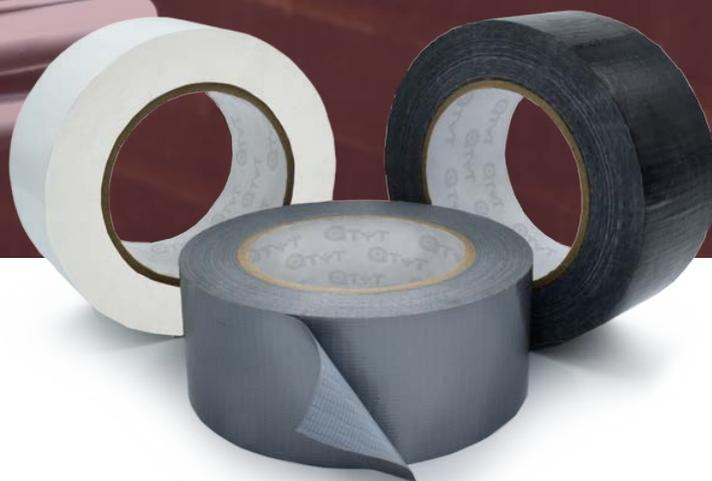
Cinta de tejido impermeable laminado en polietileno de nivel estándar con un espesor total de 165 µm, recubierta con un adhesivo sensible a la presión de resina de caucho natural.
