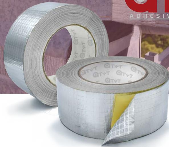
Cinta de aluminio reforzado compuesta por un soporte laminado de aluminio reforzado con fibra de vidrio recubierto por un adhesivo acrílico transparente base agua y protegido por un liner de papel siliconado.
