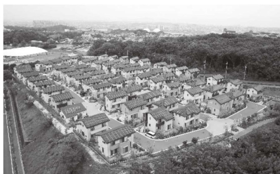
「晴美台エコモデルタウン」 泉北ニュータウンの小学校跡地(1.6ha)を活用し、再生可能エネルギーの利用、高効率な省エネ機器等を装備したネット・ゼロ・エネルギー・ハウス(65区画)の戸建住宅地
