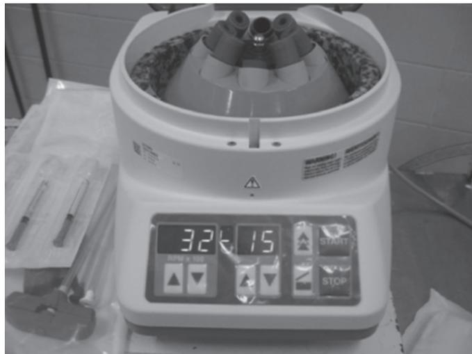
Figure 9 : Centrifugation des 6 tubes à 3200 tr/mn pendant 15minutes
