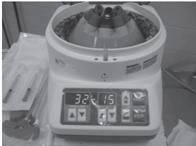
Figure 9 : Centrifugation des 6 tubes à 3200 tr/mn pendant 15minutes
