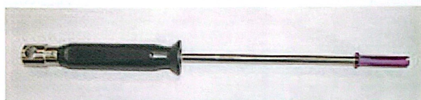
Figure 11 : Tige d'essai sur son manche
