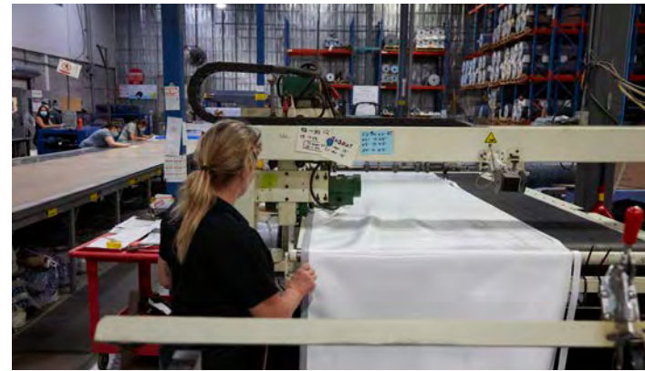
Soudage du profilé d'accrochage au mur de vinyle. Welding the hanging profile to the vinyl wall.
